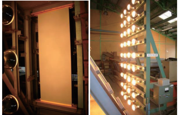
間仕切り壁パネルの加熱繰り返し試験
