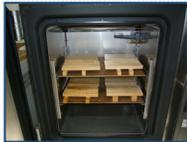
環境試験機による 乾湿繰返し試験実施状況 (パネ協中央試験場)
