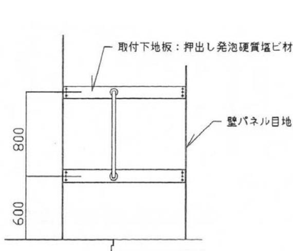
玄関縦型手摺取付詳細図
